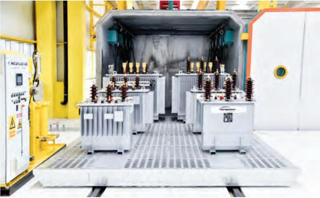
Yağlı tip transformatörlerde yağ doldurma işleminden önce, kullanılan izolasyon malzemeleri fırınlanarak kurutulur ve kazan içerisine yerleştirilir. Kurutma işleminin süresi transformatörün gücüne ve gerilimine bağlı olarak değişir.
